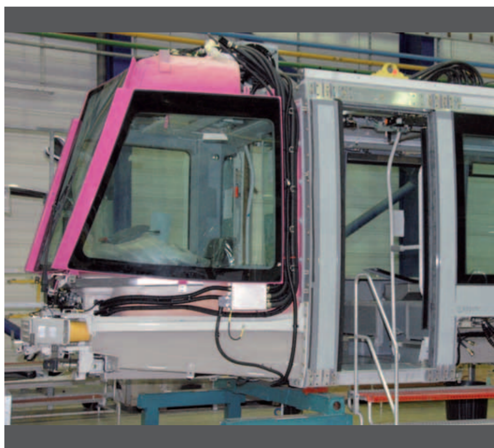
Mise en place de la cabine de conduite.
