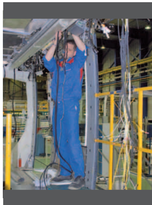
Opération de câblage de portes d'accès.
